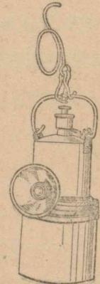
図 31 坑道の内部で用いる燈火（アセチレン燈、俗にカンテラという）
