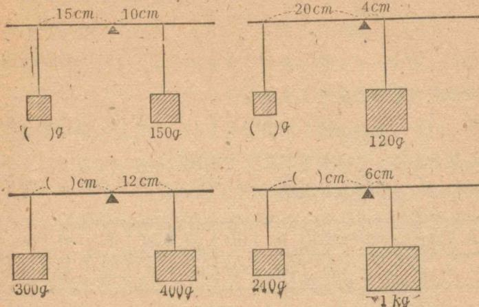
(3) 右の図のように、棒を水平に支え、その支点から  $a$ ,  $b$  のところに、重さ  $A$ ,  $B$  の物を掛けて、つり合ったとする。
