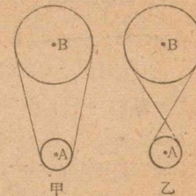
(1) 甲図のように調べ帶を掛け、A 軸を毎分 600 回の速さで右まわりに回轉させると、B 軸の
