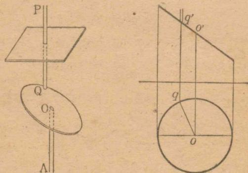
また、上の右の図は、P の運動を調べるために書いた投影図である。軸 OA と PQ との距離が 3 cm で、円板は軸に対して  $60^\circ$  傾いているものとする。軸を毎分 10 回の割合で回
