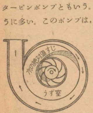
第96図(b) うず巻ポンプの流れる方向を示す
