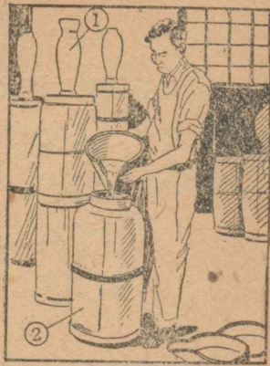
第 1-10 図 陶磁器の流し込みによる成形 ①製品 ②型
