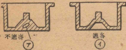
第5-52図 ダイカスト製品の壁の厚さの不均一を除く設計変更
