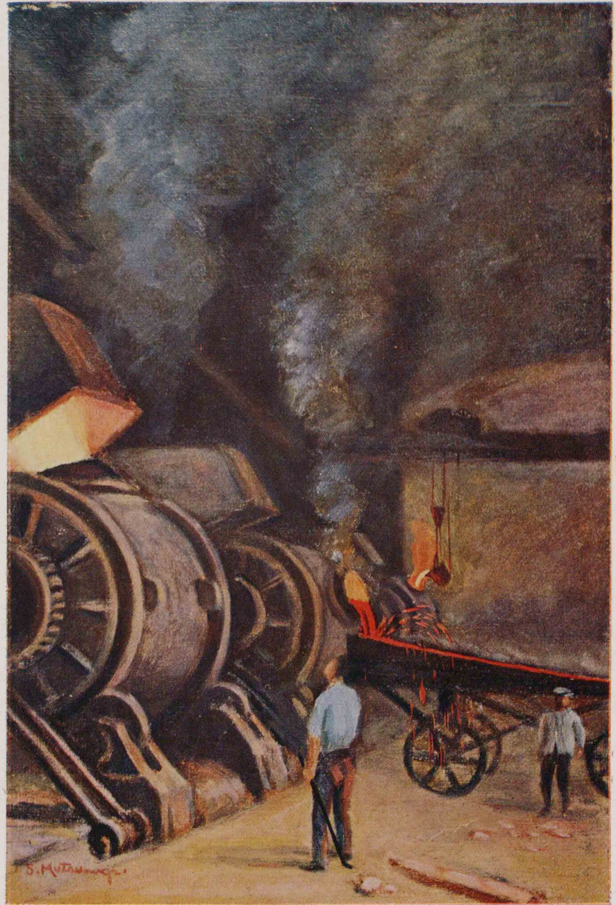
日立鑛山の製煉所。遠景は熔鑛爐から運ばれた鉄を轉爐に注入するところ。近景はそれに送風して強熱するところ。中景は轉爐を傾けて鉄滓を流し出す有様を示したものである。
