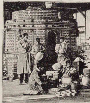
(陶器窯) (尾張瀬戸) (左は、在來の窯で登窯と稱へ、最下の室に薪を入れて燃し、その上方の室に陶器をつめて焼くので、側面に見える孔は品物の焼け工合を見るためのものである。燃料は松材を用ひる。右は、石炭を用ひて焼く洋式の窯である。)
