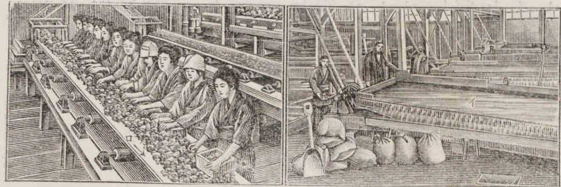
(手選選鑛) (ロは絶えず廻轉する無極帶で、イから流れてその上に乗つて來た鑛石を手で選り分ける。)
