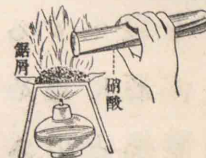
第 18 圖 硝酸の酸化作用。
