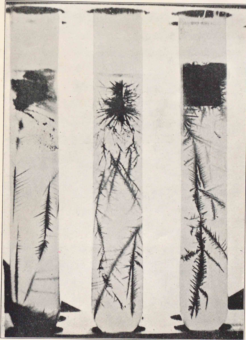
(左) 醋酸鉛の溶液(濃度 0.1 規定)を試験管に取り、その上方に錫片を吊し、ゼラチンを少しく溶し込み、約 3 週間放置する。錫の一部が底に沈んだため鉛樹が底よりも生成した有様。(中) 錫の代りにカドミウムを醋酸鉛の溶液中に吊した場合の鉛樹。(右) 錫の代りに鐵を吊した場合の鉛樹。 (イオン化傾向参照)
