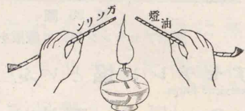
第 99 圖 揮発油と燈油との引火點比較。
