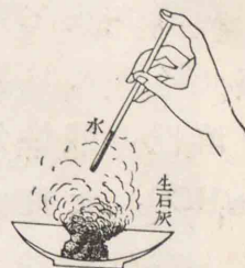
第82圖 生石灰に水の滴下
