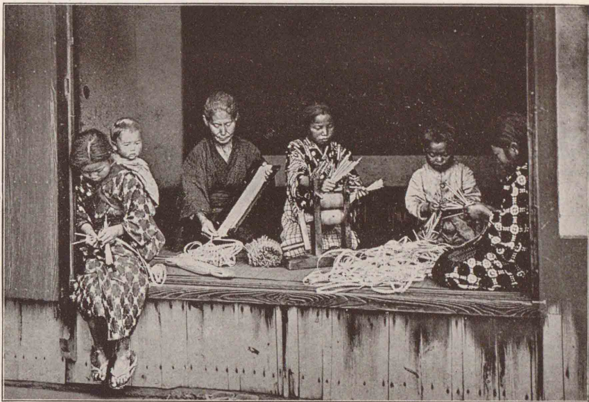
眞たつ上來出は左中しく柔を稗麥でルーロは右中で手み編は右左 製編の田眞稗麥 るあで業副の庭家るな要重りなに手の子女婦・兒小はく多 のもく巻を田
