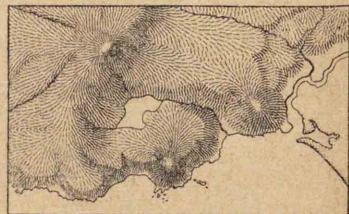
上羽の地形を表現する等高線と毛羽暈滲式ポカシ等を用ひるが、補助として此等を併用し、又は彩段式にすることもある。
