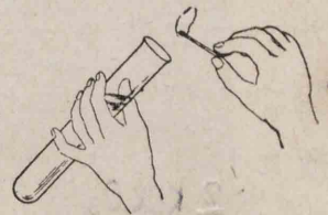
第14圖 電解によつて生じた水素を燃やす
