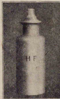
第72圖 パラフィン製の弗化水素酸容器
