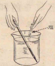
(圖131) 食鹽を水に投げ ると温度が下る
