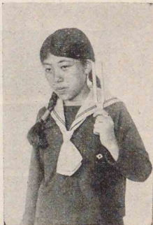
(圖305) 鳴りつゝある音叉を耳のそばで廻すと一廻りのうち四回音の弱い所がある
