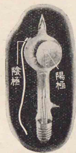
(圖551) 光電管とその接続
