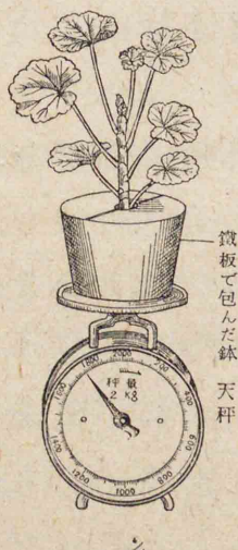
蒸散作用を量る装置
