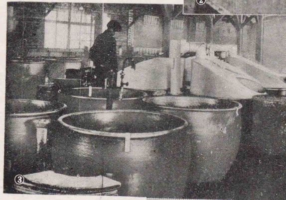
④豫和作業で、精製したニトログリセリンに、弱綿薬を加へ鉛製の鍋に入れて先づ約一時間位攪拌し、40°Cで、膠状物とする（裏面⑤へ続く）
