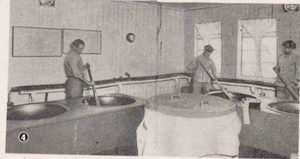
④豫和作業で、精製したニトログリセリンに、弱綿薬を加へ鉛製の鍋に入れて先づ約一時間位攪拌し、40°Cで、膠状物とする（裏面⑤へ続く）
