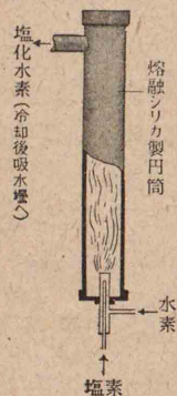
第57圖：合成鹽酸製造装置
