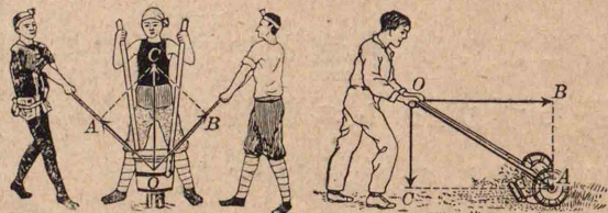
左圖は力の合成の例で力 OC が OA , OB の合力である。右圖は力の分解の例で力 OA を水平と鉛直との二分力 OB , OC に分けたものである。
