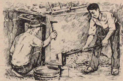
鍛冶屋の用ひる槌は運動量を大にするやうに作つてある。
