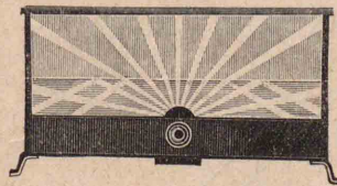
水中に細隙を設けそれから出る光の進路を示す。
