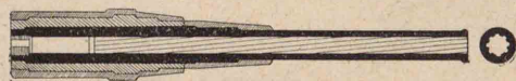
(圖450) 砲身内には螺旋狀の腔を付けて、砲彈に廻轉運動を與へて一定の姿勢を保たせる。
