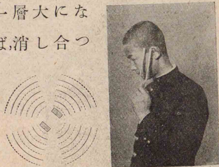
(圖529) 鳴りつゝある音叉を耳のそばで廻すと一廻りのうち四回音の弱い所がある
