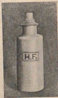
パラフィン製の 弗化水素酸容器
