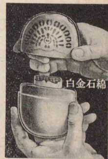
白金懷爐 白金石綿を觸媒とし揮發油を燃焼させる。
