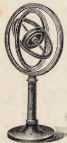
[196] ジャイロスコープ 一組の廻轉軸の一つに質量の大きい金屬製の車輪をとりつけ、これを急速に廻すと、臺を動かしても廻轉軸は一定の方向を保つ。
