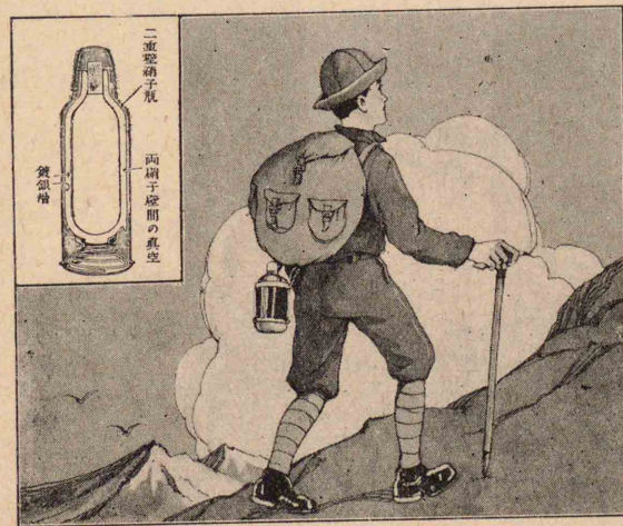
第 94 圖 魔法瓶の利用と構造
