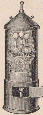
第 67 圖 蒸氣消毒器 「かび」・「バクテリア」などの純粹培養をしようとする時には諸器物・培養基などを嚴重に消毒する
