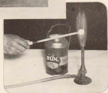
↑ 液體空氣に冷やした金屬球をガスの焰の中に入れると表面に雪を生ずる
