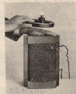
二次コイルに生じた電流で、豆電燈を點する實驗
