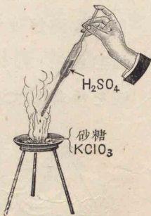
[120] 塩素酸カリの酸化作用 塩素酸カリは無色板状の結晶にて強熱すれば酸素を放つ故に酸化劑としてマッチ・花火・爆藥の製造や醫藥(含嗽用 ① )等に用ひられる。
