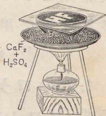
[64] 弗化水素の製取と硝子の腐蝕
