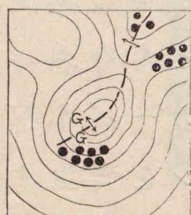
[185] 含油層(ドーム形構造) G—天然ガス井, 黒點は石油井, D—ドームの中央に石油その上にガスが集中蓄積される。
