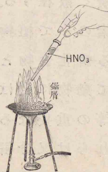
[87] 硝酸の酸化作用 鋳屑を少し熱し焦げ始めた頃、この上に濃硝酸を滴下すると、鋳屑は急に燃え始める。
