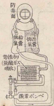
[14] 酸素呼吸器 石炭坑の爆發後坑内へ入る際等に用ひる。圖に就てその作用を調べよ。
