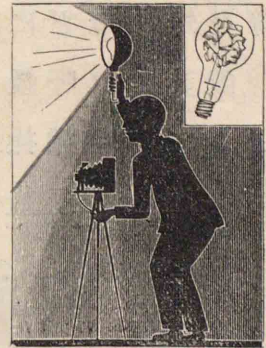
[11] 閃光電球 電球内に酸素を封入し、 線條の周をアルミニウム 箔で蔽ふ。ボタンを押すと 乾電池で點火して、アルミ ニウム箔が燃焼して閃光 を放つ。夜間の寫眞撮影等 に用ひられる。
