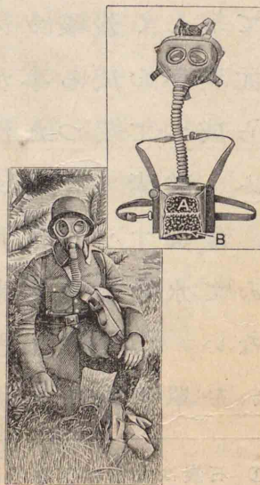
[31] 防毒面 A 活性炭 B フェルト 吸氣は上の二層を通り、呼氣は瓣より排出される。
