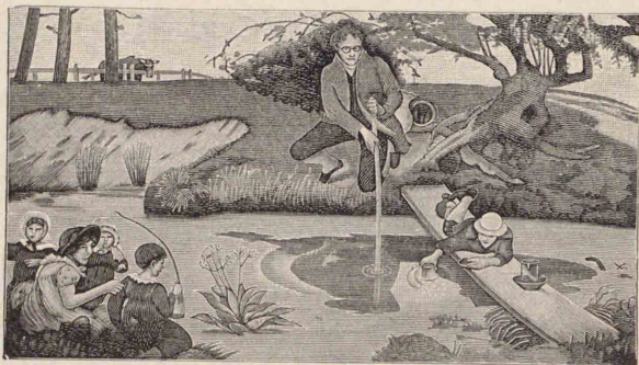
[180] ダルトンのメタンの捕集 Dalton J. (1766—1844)(英) 彼のメタン・エチレン等の組成の正確なる決定はかの有名な原子説提唱の出発点たらしめた。
