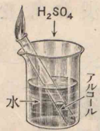
[76] 水に硫酸を溶す際の發熱 アルコールを試験管に入れて挿入すると沸騰し、點火すると管口で燃える。
