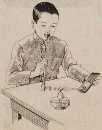
吹管を用ひて木炭上に昇華を検する
