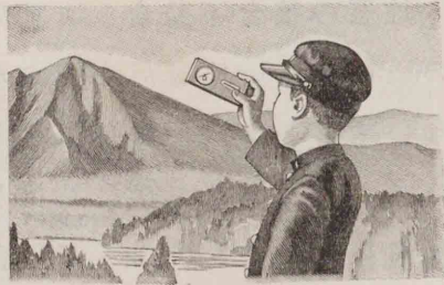
[76] 傾斜儀で遠山の勾配を測る状
