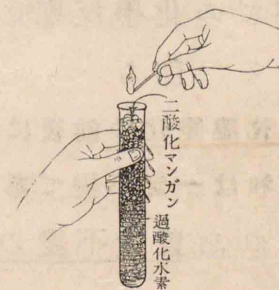
過酸化水素に二酸化マンガンを入れると容易に分解して酸素を發生する
