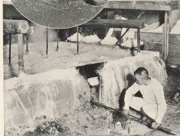
(上)塩田にて塩分の附着せる細砂を掻き集めこれに海水を注いで塩分を浸出する (中)浸出した濃い塩水は藻垂甕といふ圓形の甕にたまる、これを汲取るところ (下)上の塩水を煮詰めて食塩の結晶を得る
