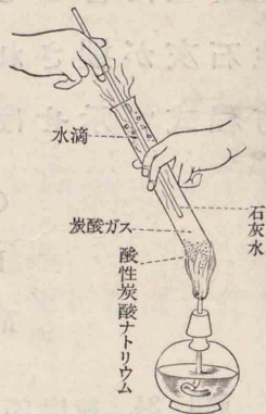
第58圖 酸性炭酸ナトリウムを熱する
