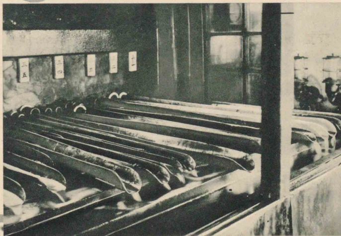
原油を分溜して各種の油を取る (圖では 3 個所に分れてゐる)
