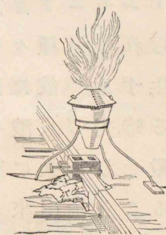
テルミットでレールを接合する
