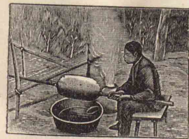
第167圖：—ゴム汁を焚火の傍で凝固させる。
