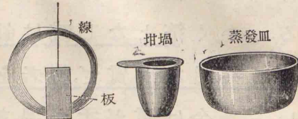
第95圖: 一白金製化學器具の例。
