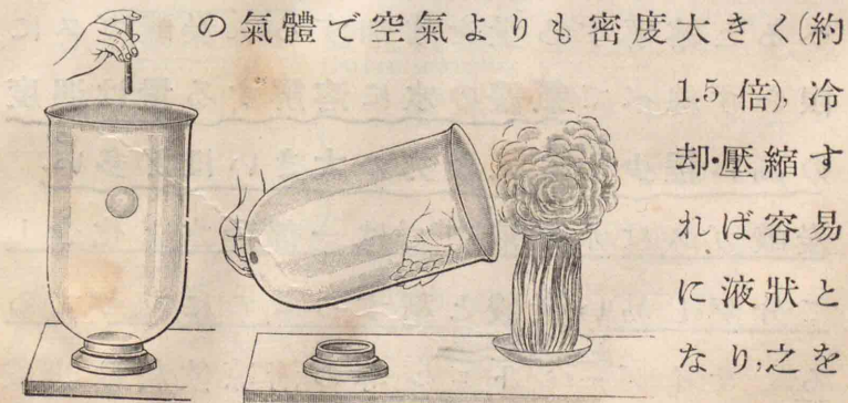
第33圖 炭酸ガスに石鹼球の浮ぶこと(左)と、 炭酸ガスの消火作用を驗す(右)。
