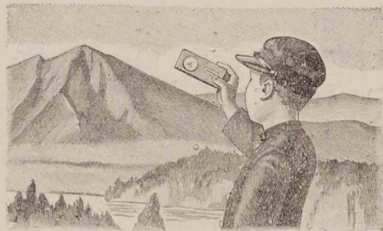
第六九圖 遠くに眺めた 山の勾配を傾 斜儀を以て略 測する状
