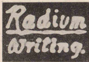
[圖 47] 寫眞乾板の上にラヂ ウム鹽で書いた字：
