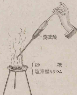
127. 鹽素酸カリと砂糖との混合物に濃硫酸を滴下してゐるところ
