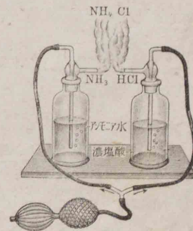
84. 鹽化水素とアンモニアと が觸れて鹽化アンモニウム ができることを示す實驗
