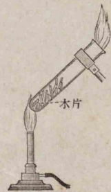
41. 木片を熱して出る氣體の燃焼
