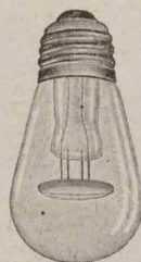
128. ネオンランプ 半圓形の二枚の金屬板が2—3mm隔てて圓形に並べてある。これに交流を通ずると板面は橙赤色に輝く。
