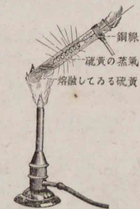
74. 硫黄の蒸氣中で銅線が赤熱されることを示す
