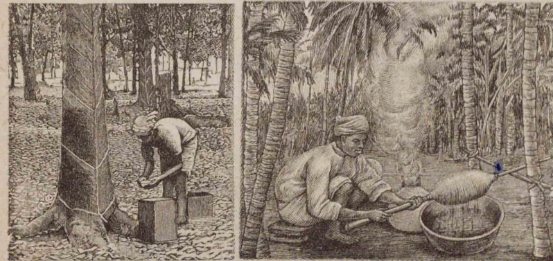
181. ラテックスを棒の上に注ぎかけ、これを廻しながら煙にあてて凝固させる。
