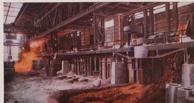
(上) 熔鑛爐の外観 (下) 平 爐 (中) 熔鑛爐から鐵を流し出して居るところ
