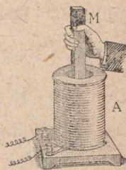
磁石による感應電流
