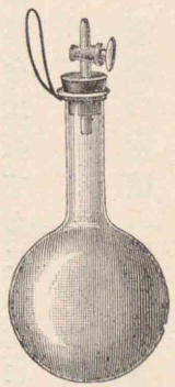
第十一圖 氣體の重さを 測るフラスコ
