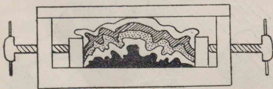
第62圖 横壓力により地層の褶曲するのを示す實驗
