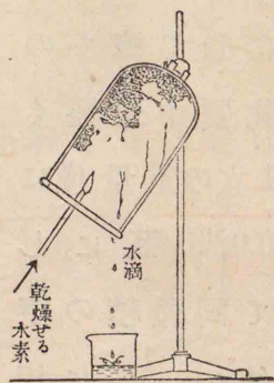
水素が空氣中にて燃燒すれば水を生ず
